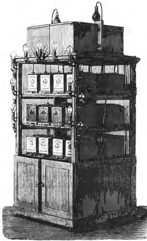
Батарея Имшенецкаго для комнатнаго элентрическаго освѣщенія.
