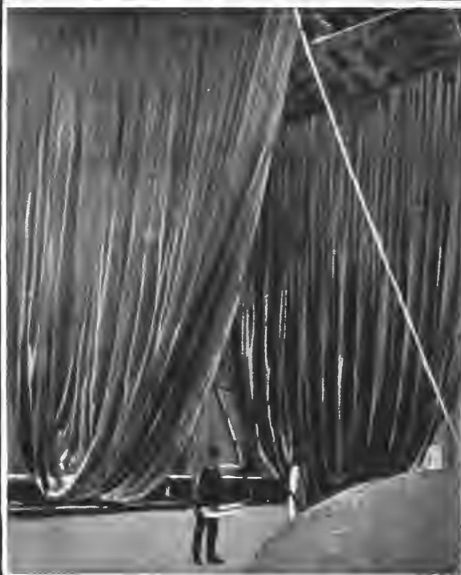
Развѣшиваніе оболочки для полного просыханія олифы, которою она смазывается.
