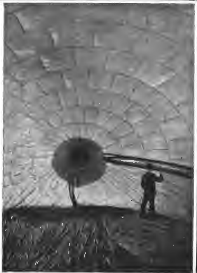
Осмотръ оболочки шара изнутри. Въ центрѣ рисунка—клапанъ, а справа—разрывная полоса для выпуска газа.
