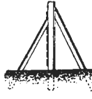
Деревянные загородки для защиты пути от снежных заносов.
