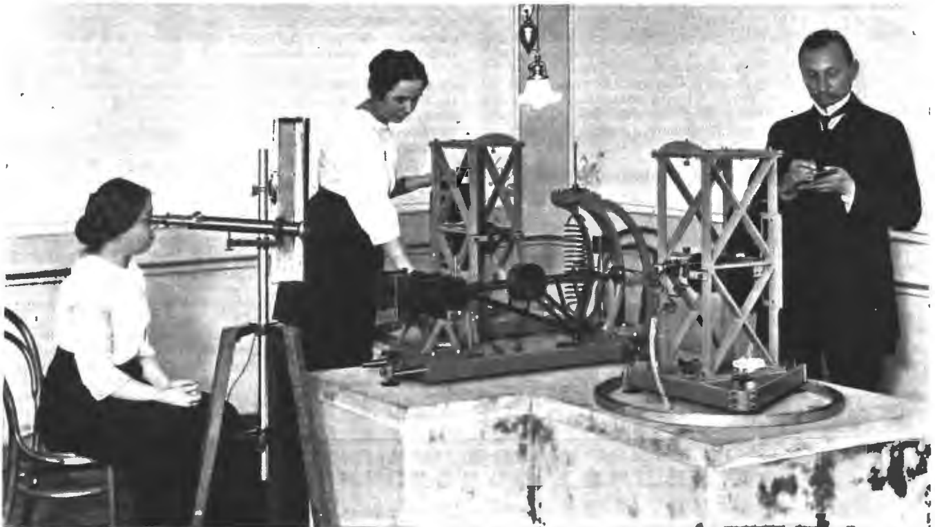
Землетрясеніе и сейсмографъ. Горизонтальный и вертикальный маятники для опредѣленія землетрясеній системы кн. Б. Голицына, установленные на новой центральной сейсмической станціи въ Николаевской Главной астрономической обсерваторіи въ Пулковѣ. По фот. К. Булла.
