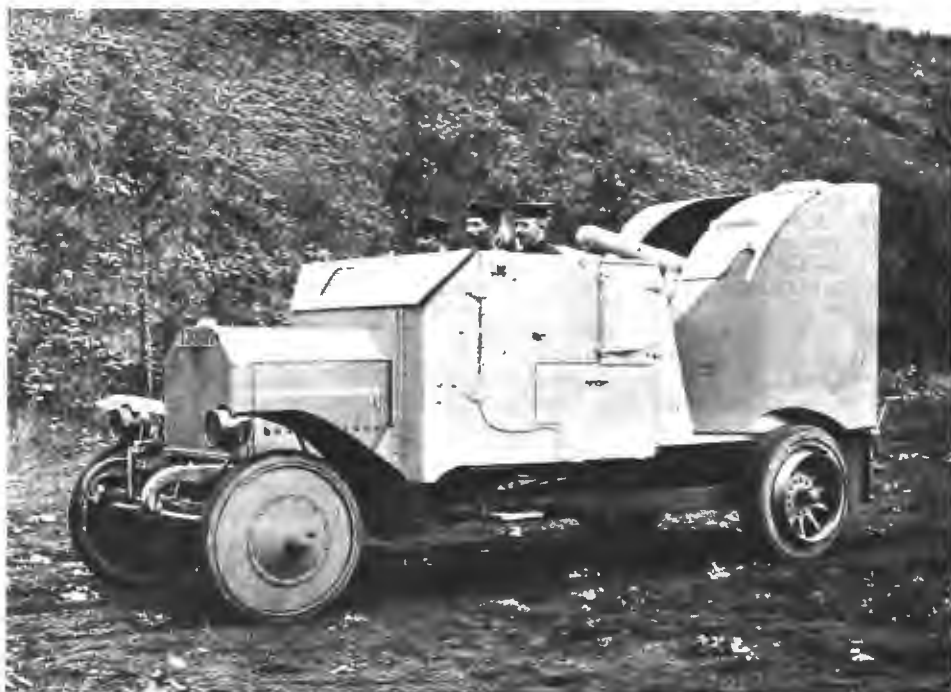
Бронированный автомобиль съ установленной на немъ пушкой, приспособленной для стрѣльбы по летательнымъ аппаратамъ (работы Круппа).
