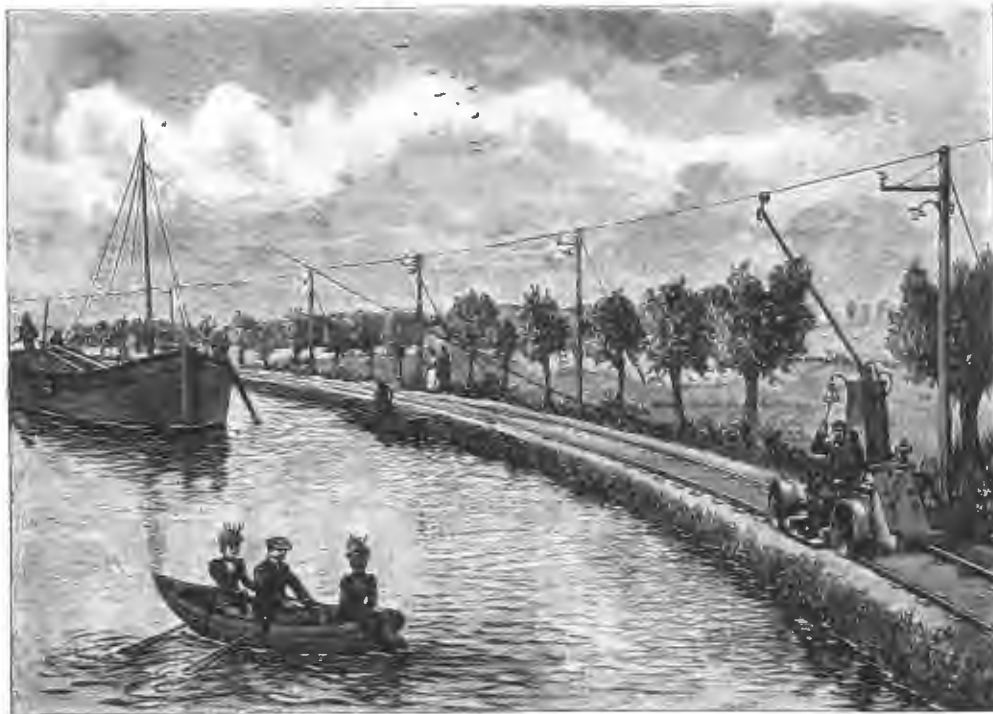
Электрическая тяга судовъ на Финновскомъ каналѣ, у Эберсвальде (Германія). Электрическій локомотивъ въ движеніи.
