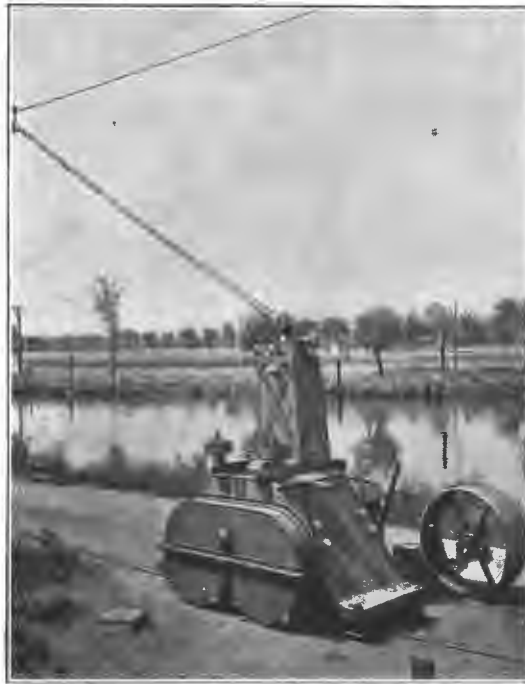
Электрическая тяга судовъ на Финновскомъ каналѣ, у Эберсвальде (Германія). Электрическій локомотивъ въ движеніи.
