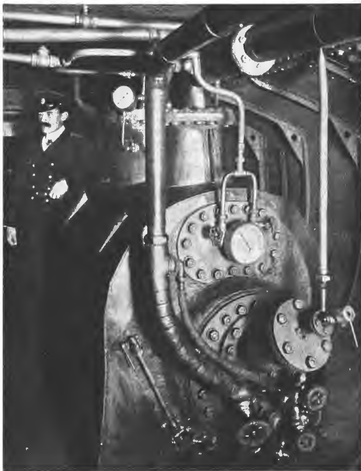
Видъ котла системы Шмидта со стороны топки.
