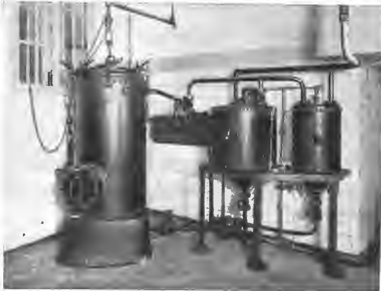
Утилизационно-стерилизационный аппарат Делякура-Воеводскаго для переработки отбросовъ и бракованнаго мяса на сало и туки.
