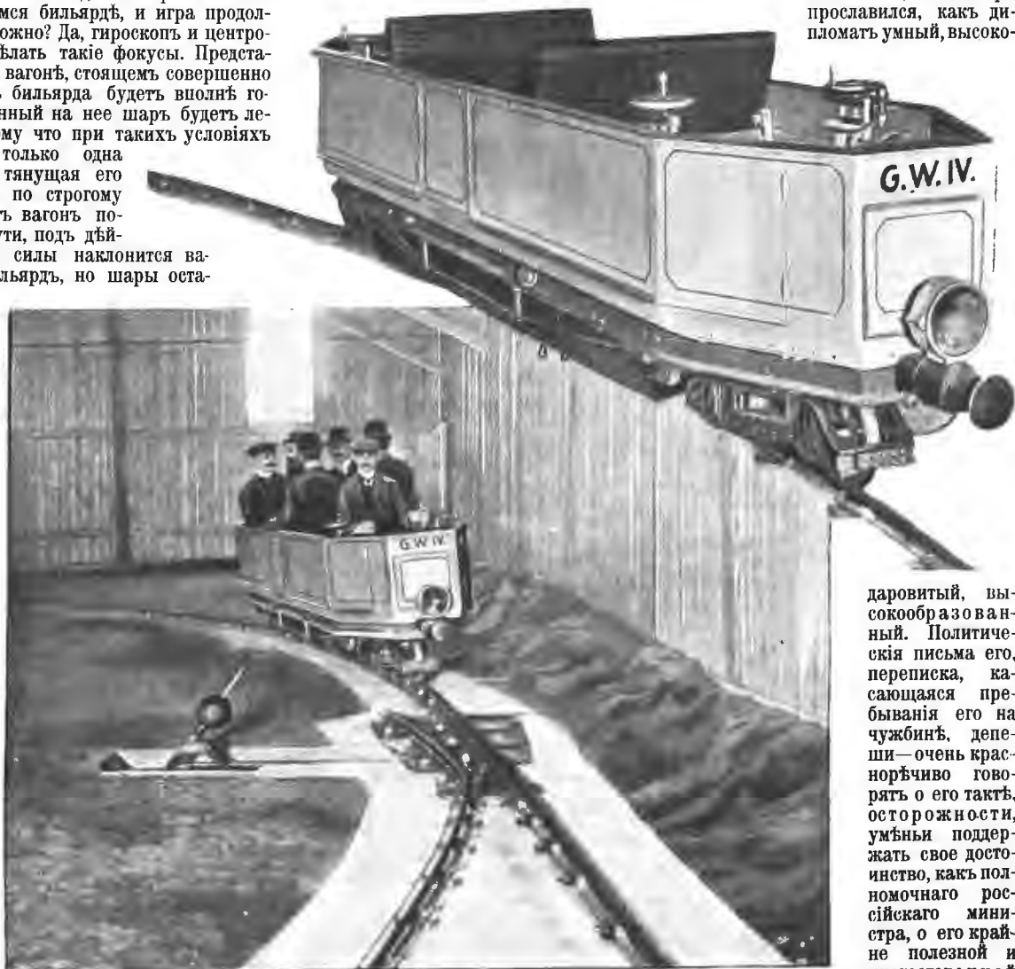
Однорельсовая дорога системы Шерля. Вверху — вагонъ, внизу — испытаніе вагона въ Берлинскомъ зоологическомъ саду.
