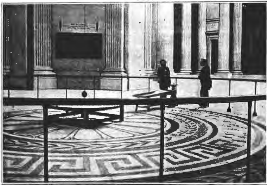
Повторение опыта Фуко в парижском Пантеонѣ. Кругъ, въ которомъ движется маятникъ. По фот. авт. «Нивы».
