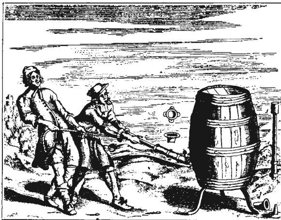
Опытъ Герике съ бочкой—для образованія безвоздушнаго пространства. По старинной гравюрѣ авт. «Нивы».
