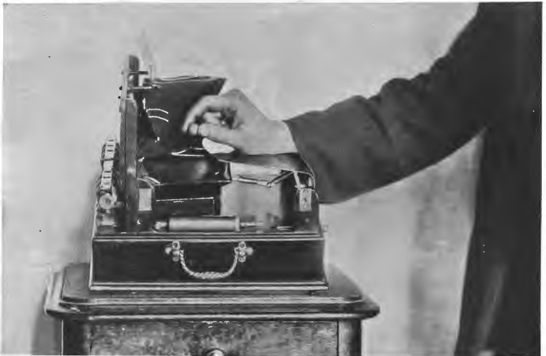
Новый баллотировочный аппаратъ А. Р. Свѣнцицкаго. Рис. 2. Механизмъ приема баллотировочнаго шара.
