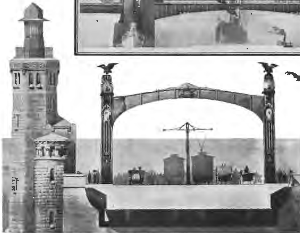
Будущий мостъ на Охту черезъ Неву. Одобренный къ постройкѣ проектъ профессора Кривошеина. 1) Перспективный (общій) видъ. 2) Разводная часть и двѣ башни-быки со стороны ледорѣза. 3) Поперечный разрѣзъ моста. По фот. В. Подонскаго авт. «Нивы».
