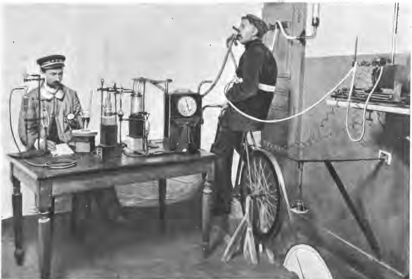
Определение энергии, расходуемой человекомъ при ѣздѣ на велосипедѣ, путемъ вычисленія количества потребленного кислорода и выдѣленной углекислоты.
