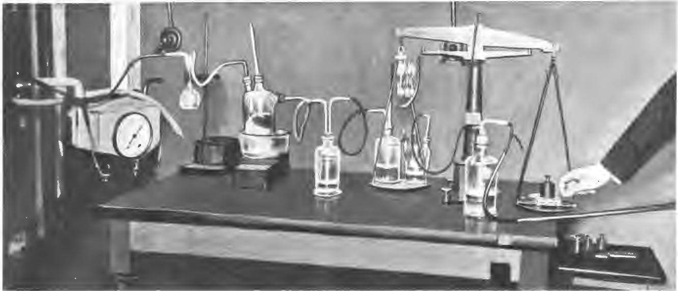
Определение энергии, расходуемой организмом морской свинки во время покоя. Морская свинка помещена в специальную стеклянную камеру, при чем может быть вычислено количество выдѣлившейся при дыханіи углекислоты и потребленного кислорода.
