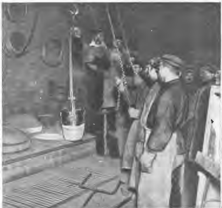
Поднятіе тигля съ расплавленной бронзой для отливки фигуры памятника.
