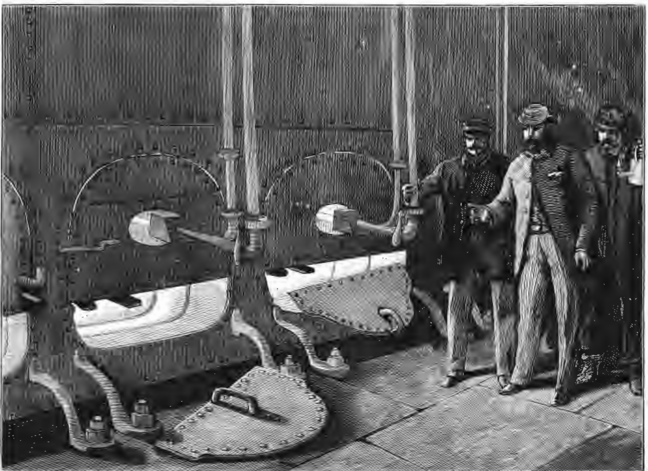
Котлы на пароходѣ Каспійскаго пароходства съ нефтянымъ отопленіемъ. Рис. Симпсонъ, грав. Флюгель.
