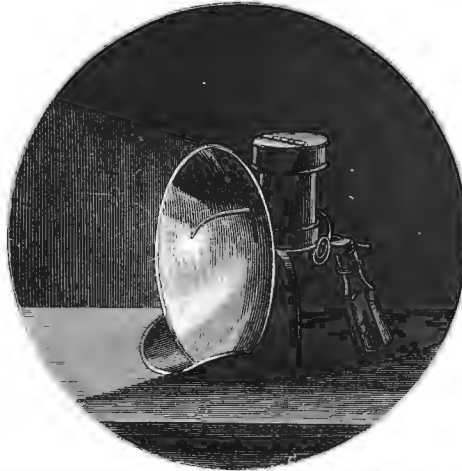
Рис. 2. Аппарат для освещения вспышками магния.
