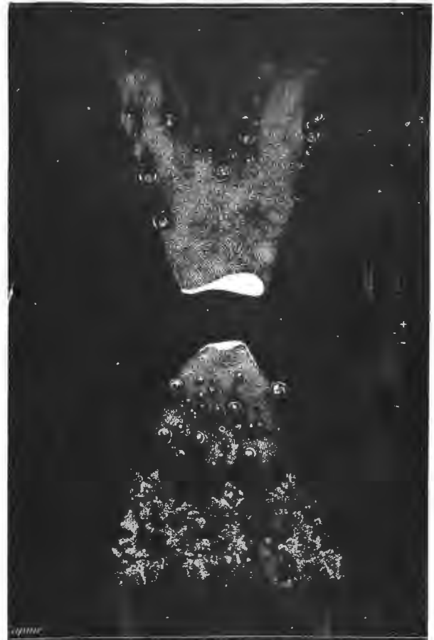
Рис. 4. Острия угля (въ увеличенномъ видѣ) во время получения электрической дуги.
