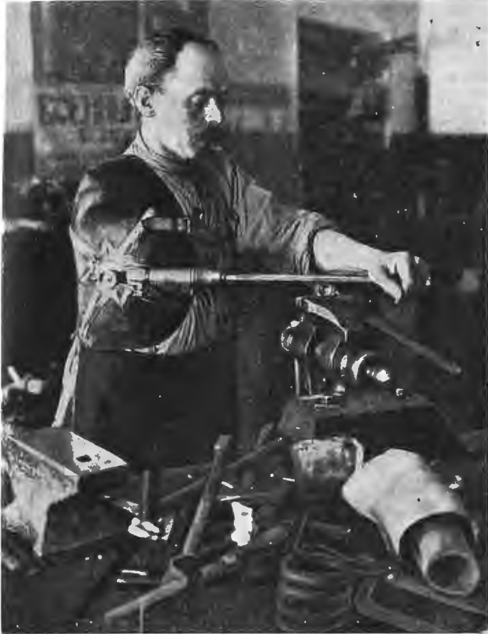
Въ ортопедическомъ отдѣленіи Максимиліановской лѣчебниці. Слесарь съ ампутированной правой рукой работаетъ при помощи спеціального приспособленія металлическія части для протезъ.
