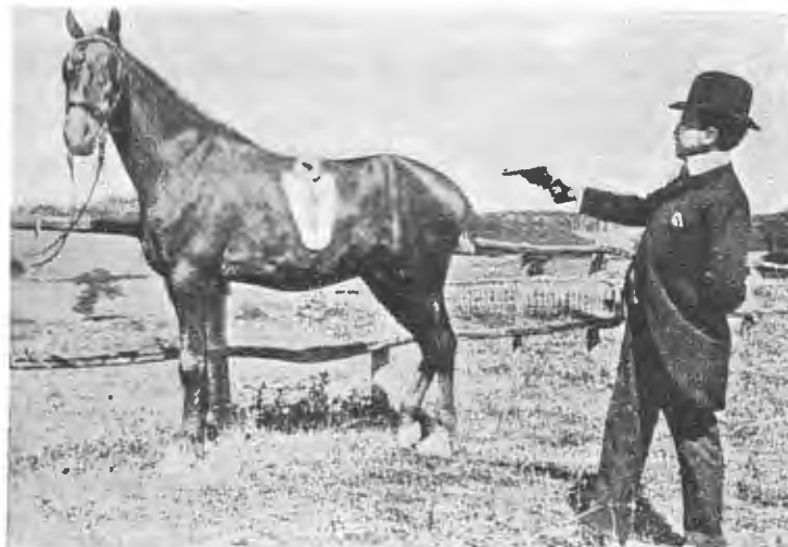
Изобрѣтатель непроницаемаго панцыря, Бенедетти, стрѣляетъ изъ револьвера, принятаго въ итальянскихъ войскахъ, на разстояніи 2-хъ метровъ (2 3 / 4 аршина),—въ лошадь, защищенную его панцыремъ.
