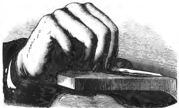
Какъ возникаетъ № „Нивы“. 5) Способъ держать грабштихель при работѣ.
