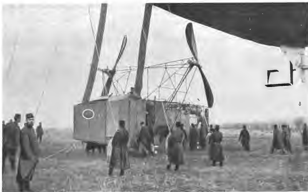
Новый французскій дирижабль съ блиндированной гондолой. Передъ подъемомъ.
