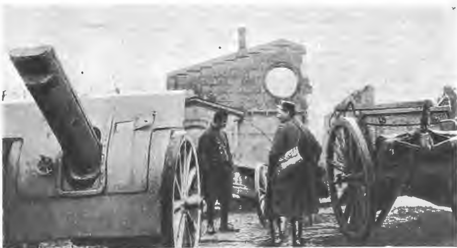
Уставшее орудіе. Французская пушка, расколовшаяся отъ длительного огня.
