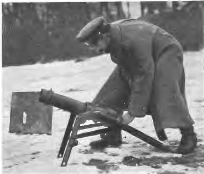
Германскій минометъ, прозванный нашими солдатами „лягушкой“, захваченный нашими гренадерами. Аппаратъ стрѣляетъ минами, снаряженными динамитомъ.
